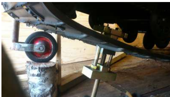
Ett kraftfullt verktyg för att montera bandskoningar
