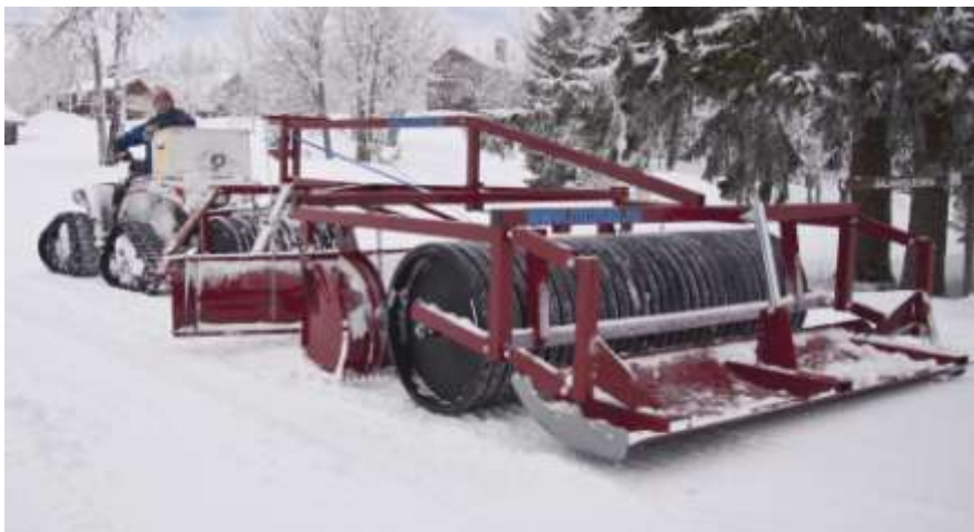
Dragfordonet, en 6-hjuling med bandaggregat och spårmaskin
